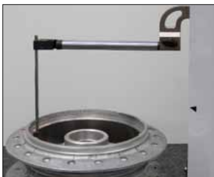
Измерение пазов с использованием поворотного держателя и L-образной измерительной вставки
